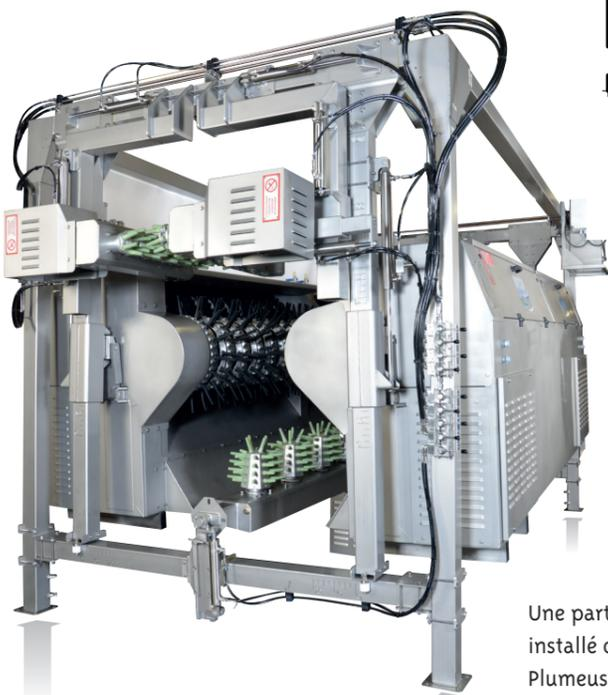
Une partie de l'équipement installé chez La Belle Farm : Plumeuse contre rotation **PGT 1815**
